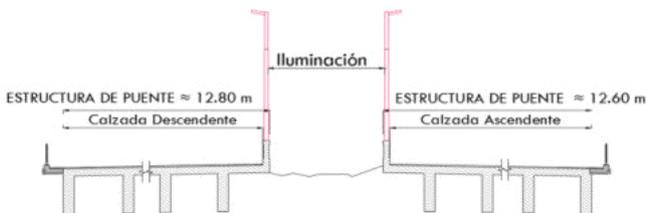
Calzada Puente sobre rectificación Río La Matanza. Esquema general
