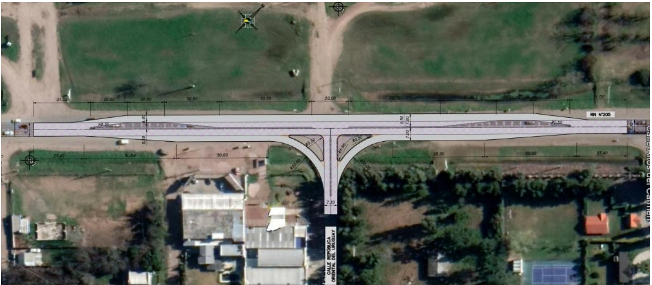
Imagen 22: Implantación de Intersección a Nivel Tipo T
