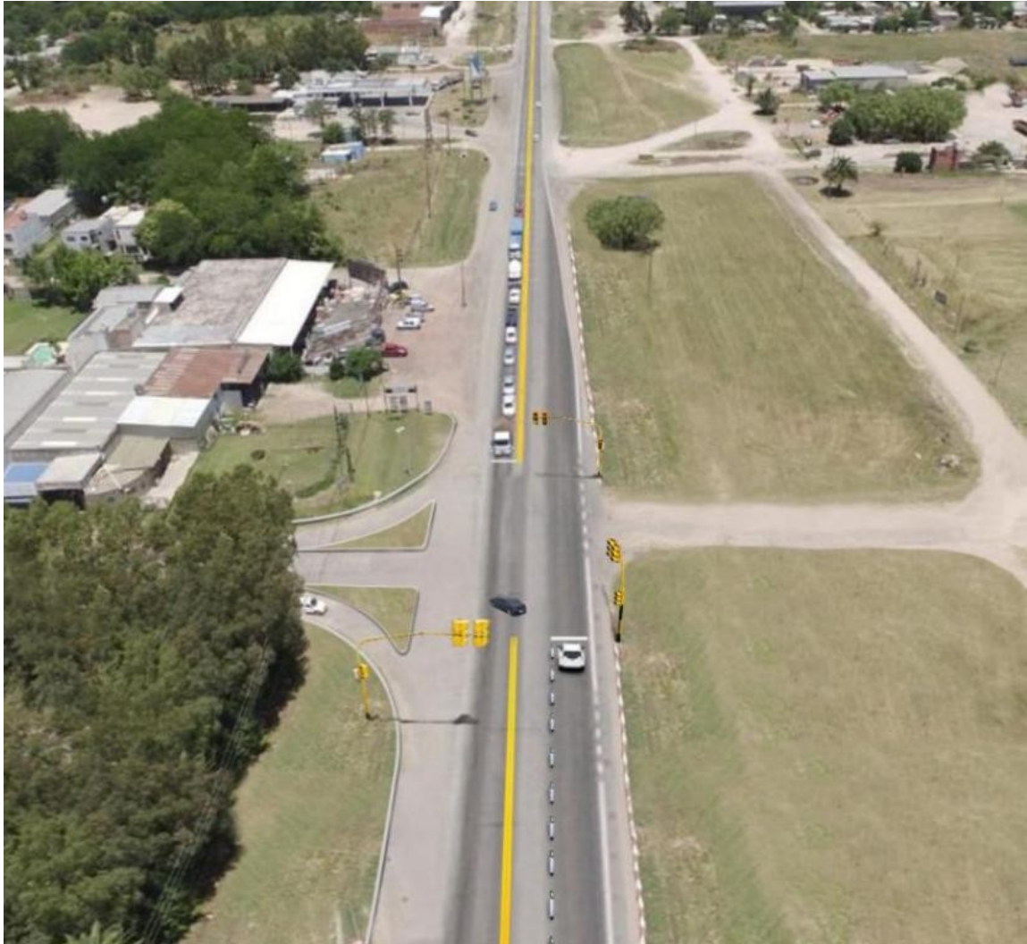
Imagen 28: Semaforización Proyectada en Intersección
