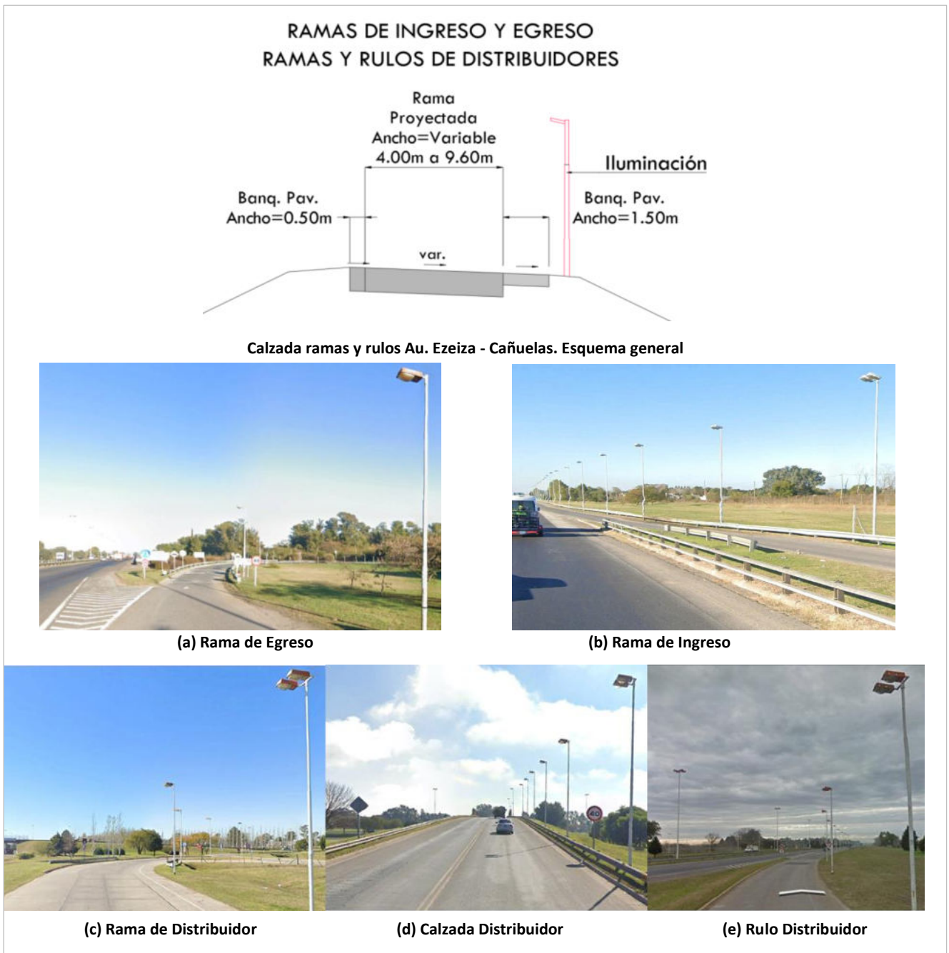
Ilustración 22 – Calzada de ramas de ingreso y egreso y ramas y rulos de distribuidores - Au. Ezeiza - Cañuelas
