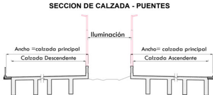
Calzada puentes Au. Ezeiza - Cañuelas. Esquema general
